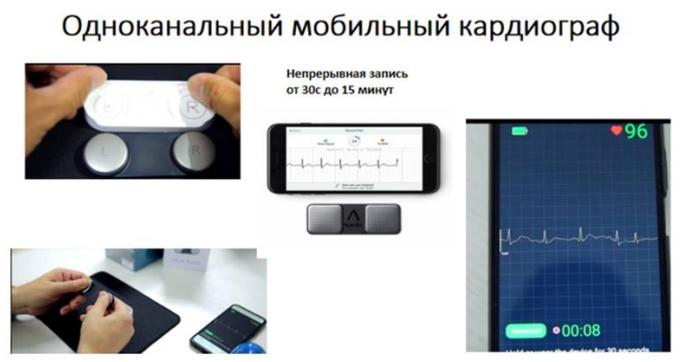
Рис. 1. Одноканальный мобильный кардиограф используется для снятия ЭКГ с пальцев рук с последующей передачей сигнала через смартфон
